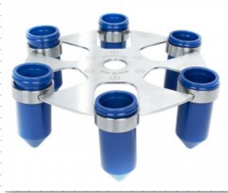
Rotor de acero inoxidable para 6 tubos
