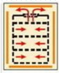
El aire y la humedad es distribuido en 6 lados dentro de la cámara por medio de un ventilador.
