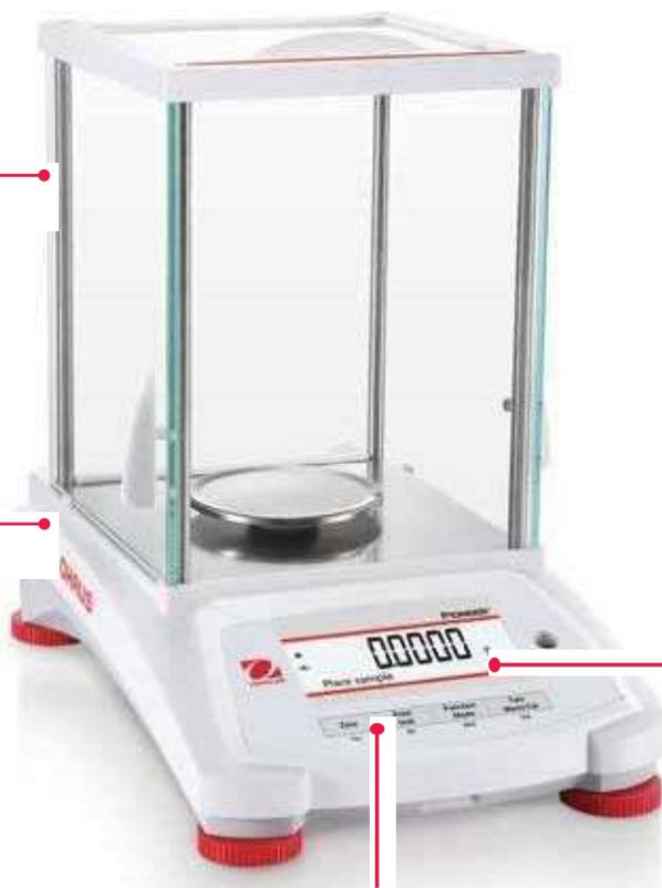
La barra de extracción estática (construida de ABS disipador de electricidad estática permanente) proporciona una ubicación de conexión a tierra conveniente.
