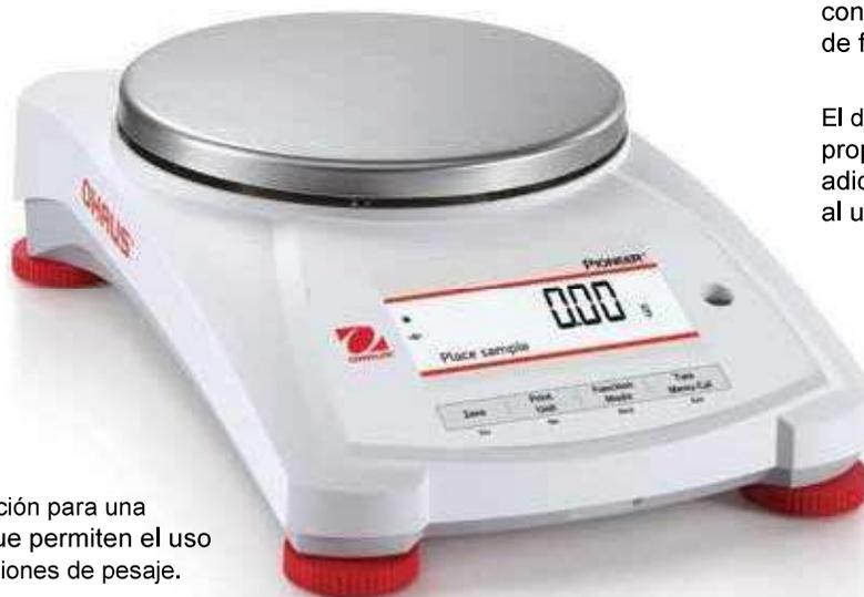
Cuatro teclas de función para una operación rápida que permiten el uso de diferentes aplicaciones de pesaje.
